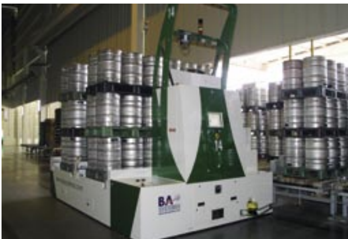
Lasergesteuerte Transportsysteme erledigen die innerbetriebliche Logistik in der Cruzcampo-Brauerei
