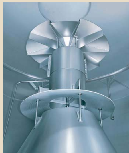
Der Jetstar™ ermöglicht die Zwei-Phasen- Kochung mit einem Innenkocher im Natu- rumlauf Quelle: GEA Brewery Systems
