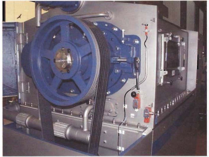
Bei den Millstar-Schrotsystemen werden neben den Behältern auch die Schutztüren der Keilriemenantriebe abgesichert
