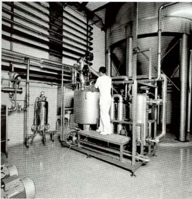
Abb. 2 Zuckerlöser Conti Stream SD 2000 H zur Heißlösung von Zucker
