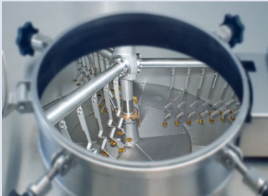
Läuterbottich mit LAUTERSTAR™ Technologie.
